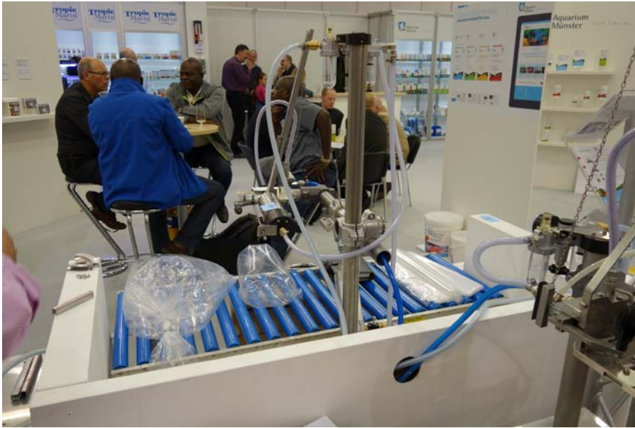
圖 25. 由德國商所開發出的半自動包裝機，可迅速注水充氧並進行金屬釦環 (clips) 的緊密封口，充分滿足了產業在活魚包裝運輸上的需求與期待。
