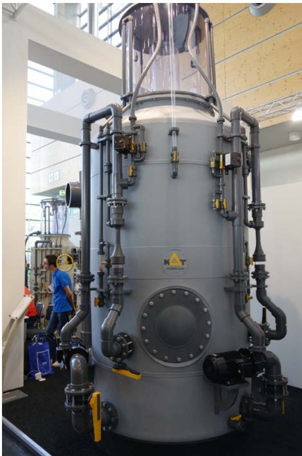
圖 20. 針對大型水族展示館或水族博物館所設計的高功率大水量蛋白質除沫裝置；導入污水處理與物理基礎的技術應用，充分滿足了特定對象的需求與期待。
